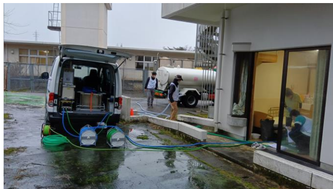
▲奥に見える給水車から手前の入浴車に給水
